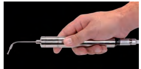
Gesamtansicht der Knochensonde im Prototypen-Stadium.
