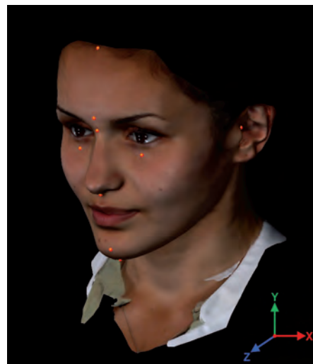
Nach der Streifenlichtprojektionsmethode erstellter 3D-Gesichtsscans einer Probandin mit eingezeichneten Messpunkten.
