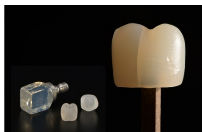
Lithiumsilikatkrone neigen zur spontanen Fraktur aufgrund thermischer Spannungen.
